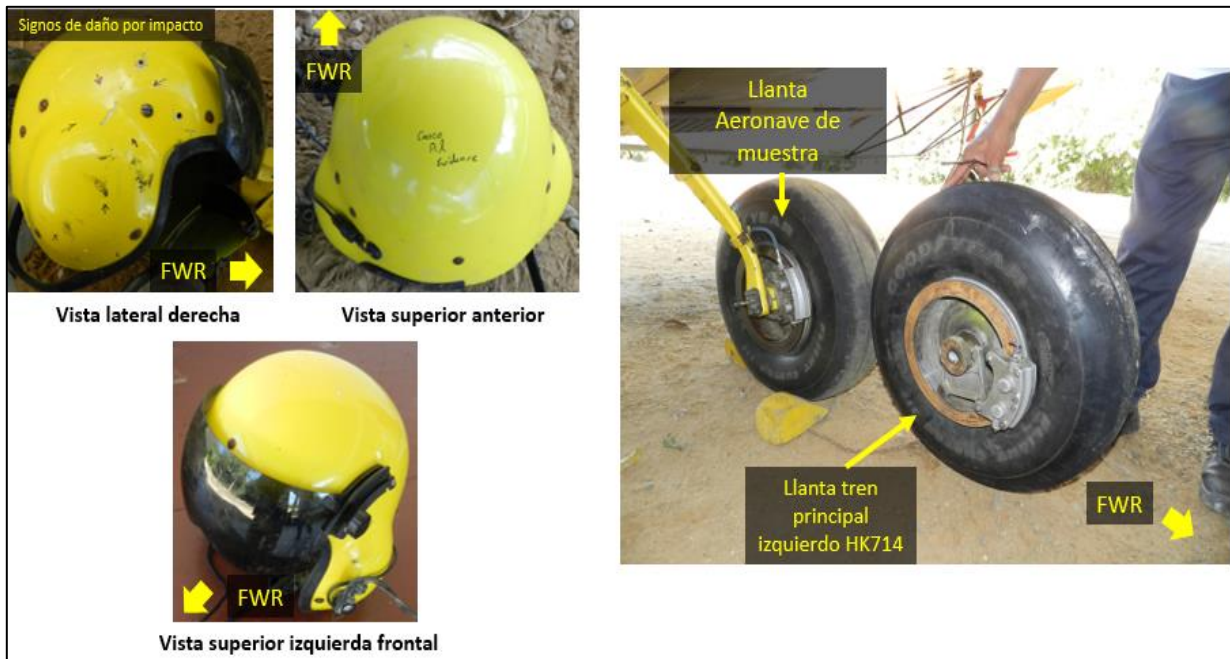
Figura 12. Condición final del casco del Piloto (izquierda) y llanta del tren principal derecho (derecha)
